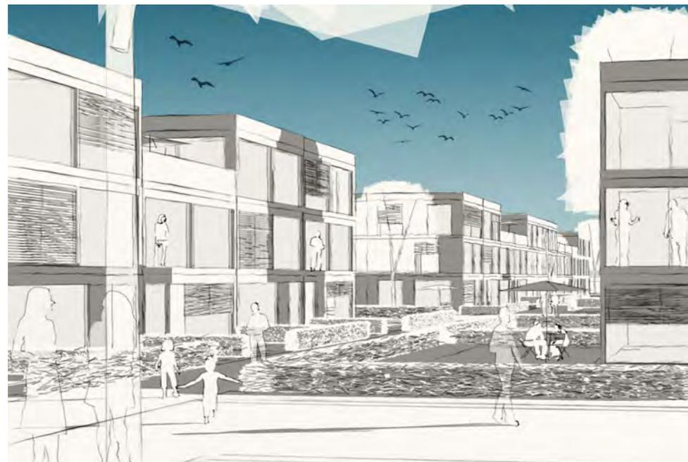
Back to Back – Reduzierung der Außenhülle – optimierte Flächenauslastung
