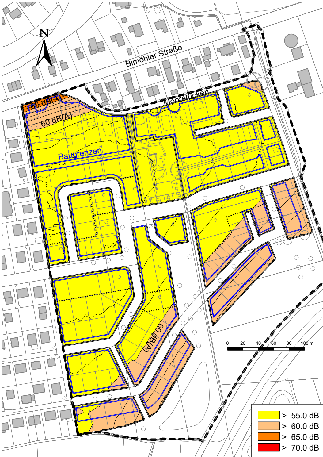
Abbildung 1: maßgeblicher Außenlärmpegel für schutzbedürftige Räume
