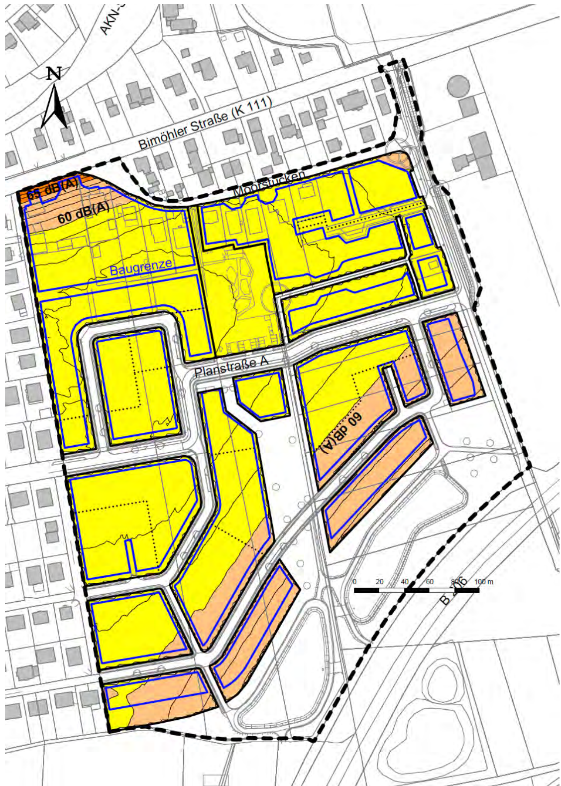
Abbildung 7: maßgeblicher Außenlärmpegel für schutzbedürftige Räume, © Lairm Consult, 2025
